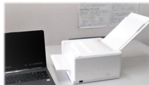
立体イメージプリンター「EasyTactix」 パソコンのデータを専用紙に印刷すると文字などが浮き上がり、触覚で内容が把握できる
